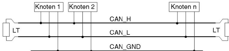
Jede CANopen-Komponente von Schneider Electric ermöglicht die Verdrahtung der folgenden Signalkabel:
