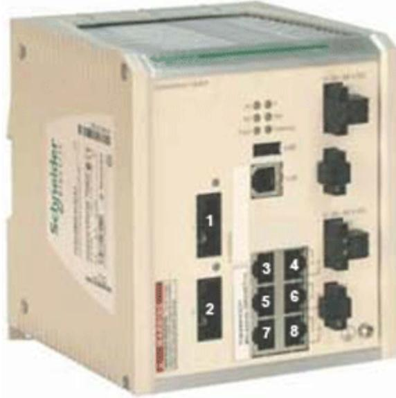
Die 3 erweiterten verwalteten ConneXium-Switches sind derzeit die einzigen DRSS, die in einem M580-System verwendet werden dürfen.
