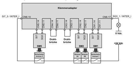
Sowohl [SQ3 function assignment] 5 [ 12 als auch [SI7 function assignment] 5 [ 13 der einzelnen gekoppelten Sicherheitsmodule sind auf SBC Feedback festgelegt.
