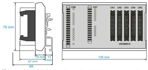
SR Platzbedarf (mit an CN1...CN5 angeschlossenen Kabeln): Kabel + 42 mm + 13 mm ≥ 100 mm.
