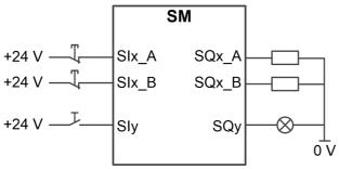
Slx\_A und Slx\_B: Sicherheitseingang x (Kanal A und B)
