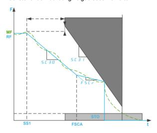
F: Frequenz/MF: Motorfrequenz/RF: Sollwertfrequenz
