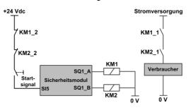
Die Verdrahtung der Kontakte KM1\_2 und KM2\_2 beim Startsignal trägt dazu bei, den Start des Sicherheitsmoduls im Falle von Schweißkontakten an den Leistungsschützen KM1 und KM2 zu verhindern, falls KM1\_2 und KM1\_1 sowie KM2\_2 und KM2\_1 mechanisch miteinander verbunden sind.
