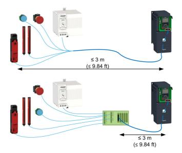
Vergewissern Sie sich, dass die Verkabelung, die Kabel und die angeschlossene Schnittstelle den PELV-Anforderungen (Protective Extra Low Voltage, Schutzkleinspannung) entsprechen.
