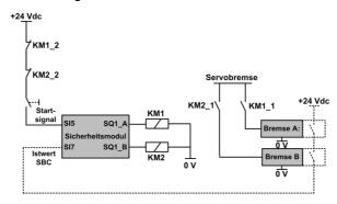
Das SBC-Istwertsignal (gepunktete Linie) ist ein optionales Signal. Die Verdrahtung des KM1\_2-Kontakts (oder KM2\_2-Kontakts) am Startsignal trägt dazu bei, den Start des Sicherheitsmoduls im Falle eines Schweißkontakts am Relais KM1 (oder KM2) zu verhindern, falls KM1\_2 und KM1\_1 (oder KM2\_2 und KM2\_1) mechanisch miteinander verbunden sind.
