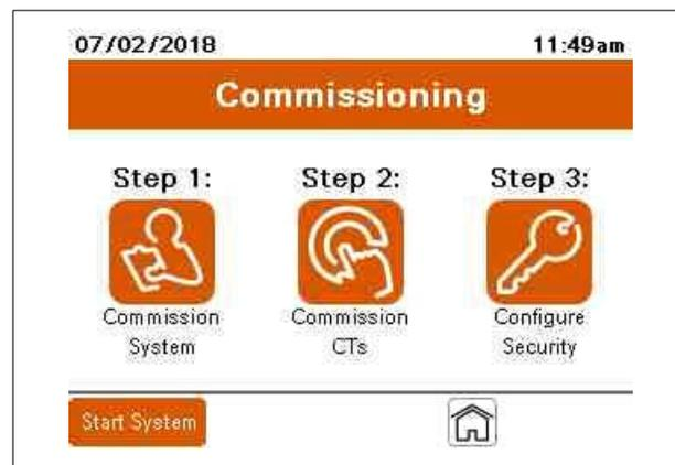
2. Drücken Sie auf das Symbol Commission CTs (Konfiguration des Stromwandlers) in Betrieb nehmen. Wählen Sie für die Stromwandlerkonfiguration entweder Yes (Ja) oder No (Nein), basierend auf den folgenden Angaben:
