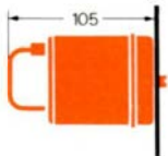
Montage sur profil DIN asymétrique
